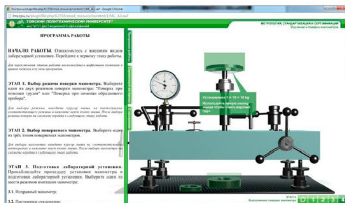
Рис. 2.13.2.3. Окно программы, реализующей виртуальную лабораторную установку (онлайн-просмотр)
